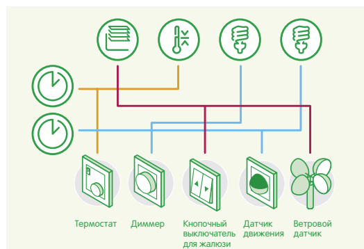
Традиционное решение: множество отдельных проводов, малая гибкость
